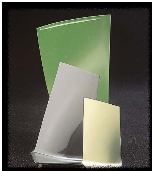
Σχήμα 3.136 Πτερύγια που έχουν υποστεί αντιδιαβρωτική προστασία με πούδρα «αλουμινίου»
