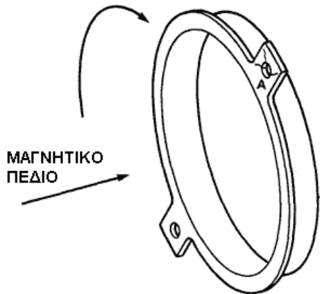
Σχήμα 3.130 Κρίσιμες περιοχές μαγνητικής επιθεώρησης ελάσματος (liner)
